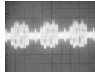
⑨ IC301 PIN51 COMB OUT(REC) Y : 20uS DIV X : 0.1V DIV
